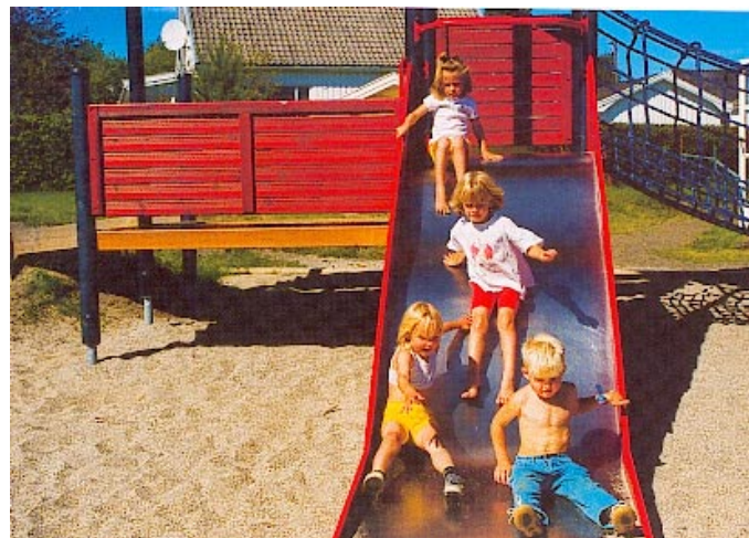
Over: Den ekstra brede sklien gjør det mulig for et funksjonshemmet barn å sitte i fanget hos en voksen.
